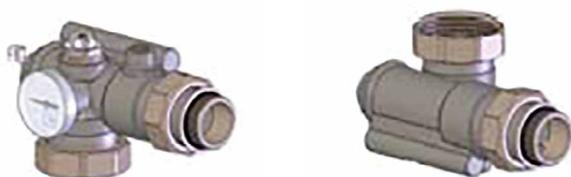
предназначен для поддержания температуры теплоносителя в системе напольного отопления с фиксированным температурным режимом. Применяется в смесительных системах отопления, которые имеют высокотемпературный контур (радиаторный) с температурой теплоносителя от  $\geq 70^{\circ}\text{C}$ ., и низкотемпературный (напольное отопление) от  $20^{\circ}\text{C}$  до  $50^{\circ}\text{C}$ .
